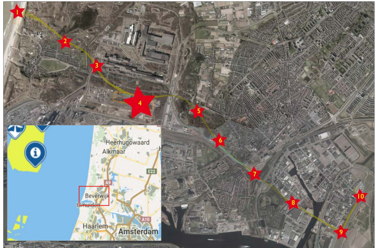
fig. 2 Overzicht kabeltracé met boorlocaties en transformatorstation
